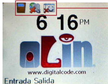
Figura 5.- Esta barra muestra la configuración del hardware principal, estatus del reloj, comunicación del reloj y cámara.
